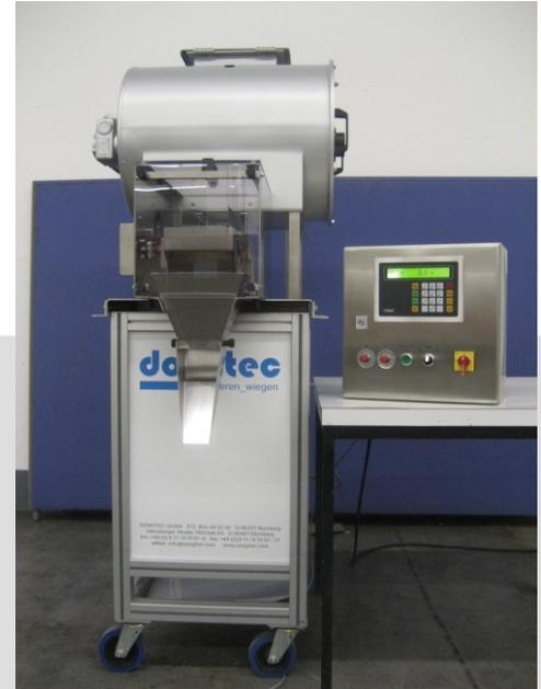
Notre balance de remplissage munie d'un tambour de mélange avec tableau de commandes séparé.
