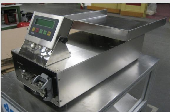
Notre balance de contrôle APW est conçue pour effectuer un contrôle et une surveillance automatique de presses à injecter, et autres installations dans le même domaine, afin de garantir la forme et la qualité des pièces.
